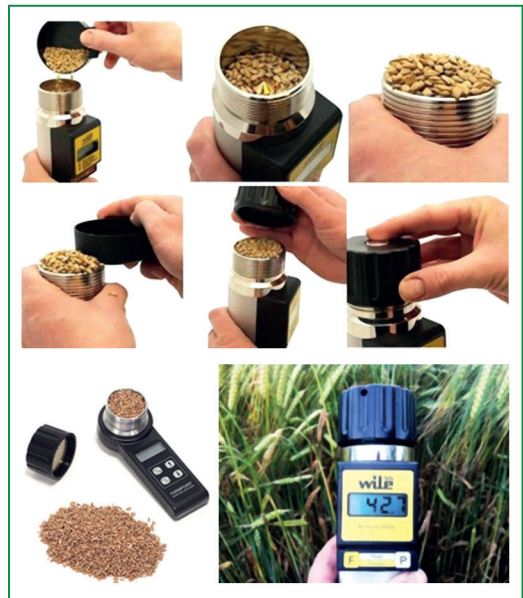
Рис. 66. Портативні вологоміри для експрес-аналізу вологості різних видів зерна
