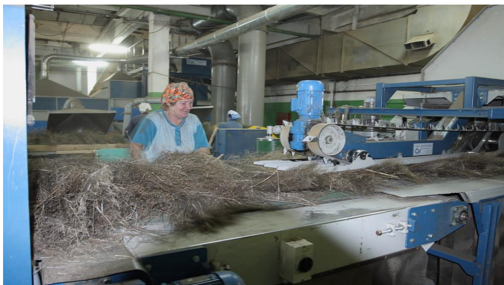
Рис. 14. Переробка трести льону-довгунцю на м'яльно-тіпальному агрегаті "Van dommele"
