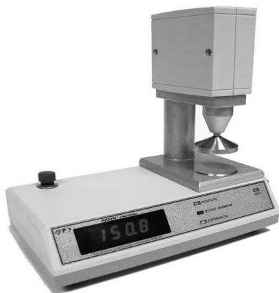
Рис. 5. Прилад ИДК-3 для визначення якості клейковини
