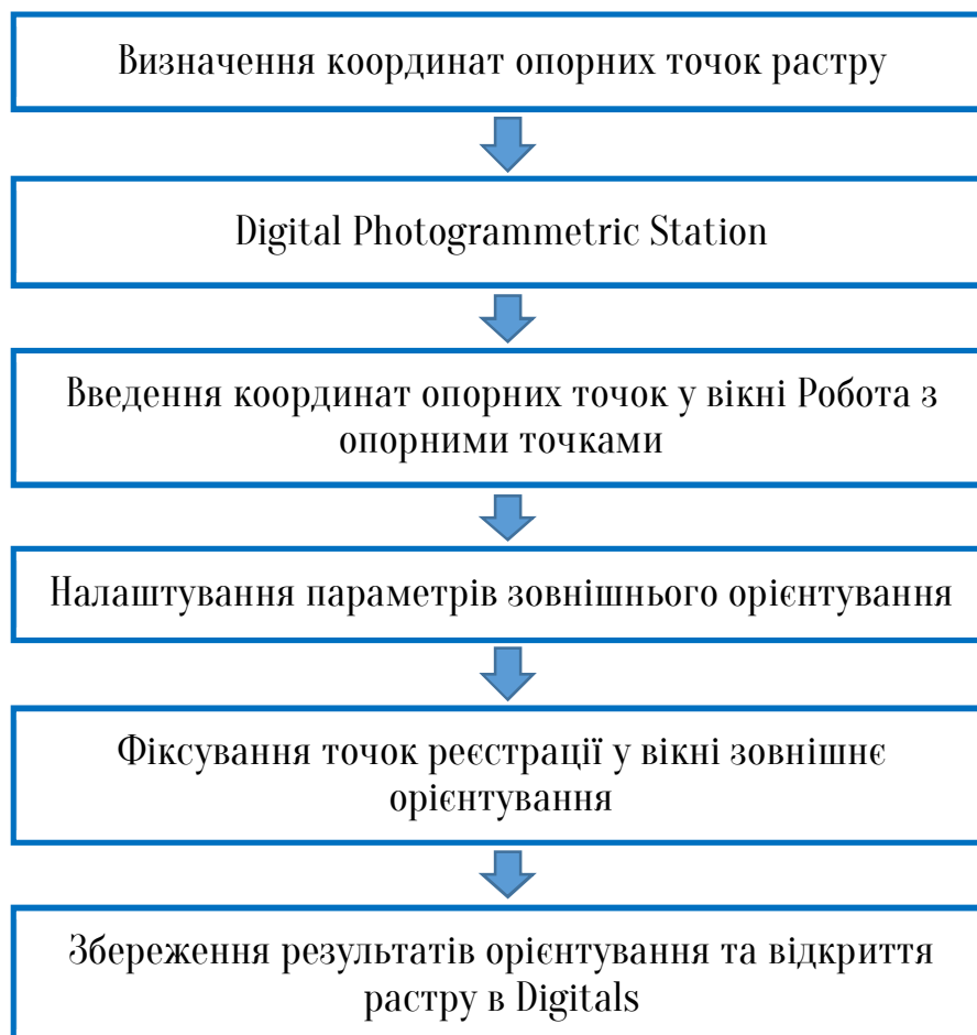
Рис. 9.1 Схема орієнтування растрового зображення
